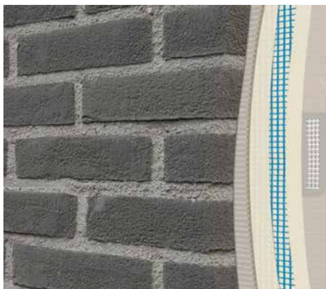
Revestimiento de ladrillo y pegamento flexible para aplacados
